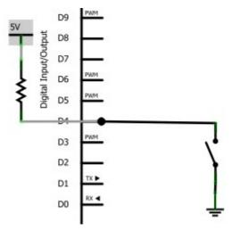
Remarque : lorsque le bouton n'est pas actionné, la broche 5 est « en l'air », le fil va se comporter comme une antenne de radio et l'état de la broche va varier en permanence. Il faut donc que le niveau logique de la broche d'entrée soit fixé en permanence. Pour cela on met en oeuvre une résistance de « pullup » qui va tirer le potentiel de la broche vers le 5V, lorsque le bouton est au repos.
