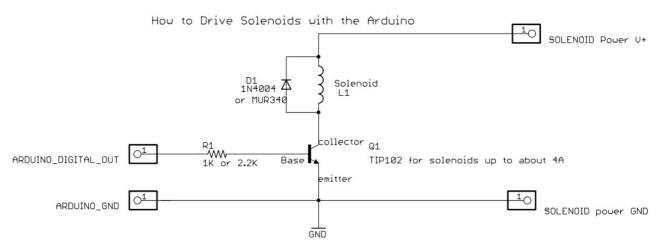
Les moteur électriques à courant continu consomment trop de courant pour être commandés directement par une broche de l'Arduino, de plus ils sont inductifs : ils créent des surtensions à leurs bornes, il faut donc protéger le montage avec une diode de roue libre.
