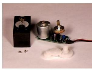
Un servomoteur est constitué d'un moteur, d'un capteur de position et d'un régulateur électronique. Le fonctionnement du moteur est asservi à la position de l'axe.
