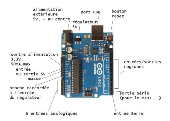
La carte Arduino repose sur un circuit intégré (un mini ordinateur appelé également micro-contrôleur) associée à des entrées et sorties qui permettent à l'utilisateur de brancher différents types d'éléments externes.
